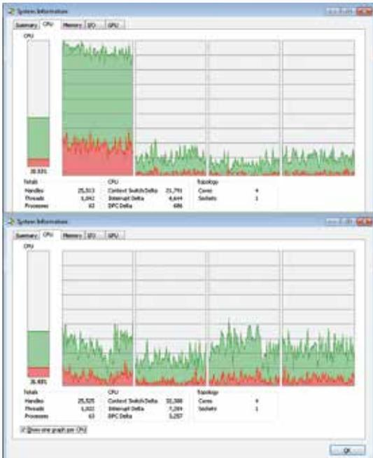
图 4: CPU 负载; 顶部: 单个核上的显卡负载, 底部: 所有四个核上分配的显卡负载
